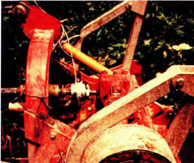
Slika 11. Torzijski dinamometar ugrađen u kardansko vratilo sitnilice Figure 11. Torque transducer assembled on PTO shaft
