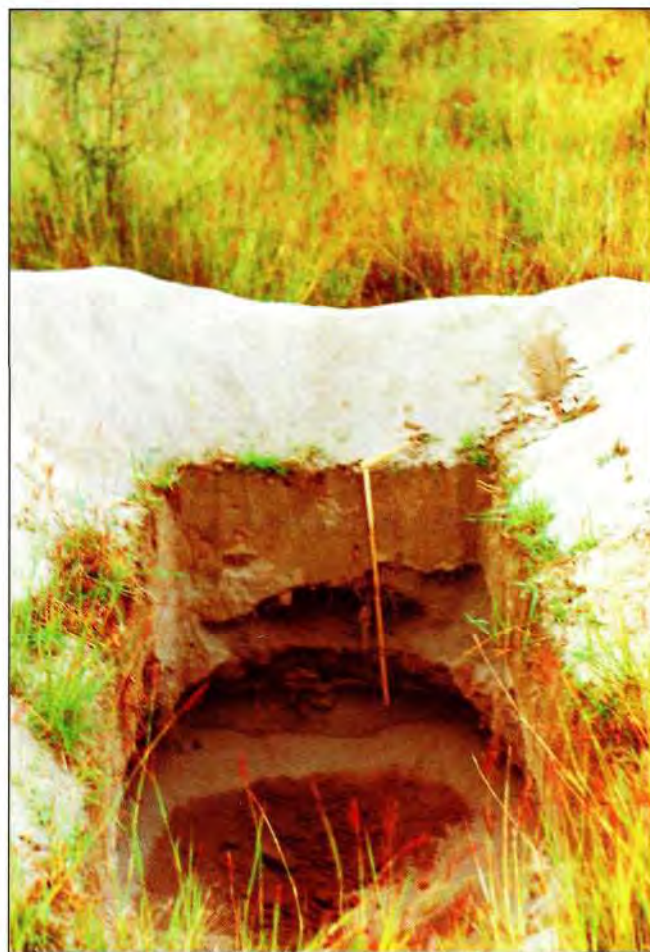
Slika 1. Profil sa slojevima nepovezanog pijeska koji se zarušava. Miho-ljačke podravske šume odsjek 3b
