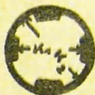
Sl. 2. Način mjerenja kalibra risanice. K_1 = promjer izbočenja, K_2 = promjer udubljenja
