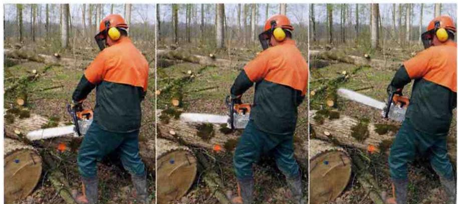
Slika 51 - Povratni udarac motorne pile
