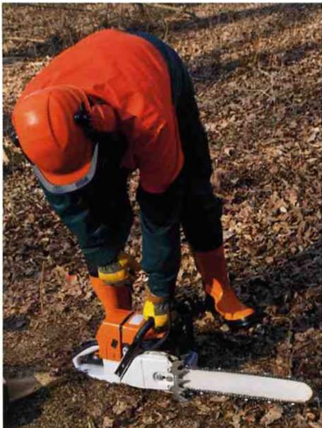
Slika 3 - Stavljanje motorne pile u pogon na zemlji
