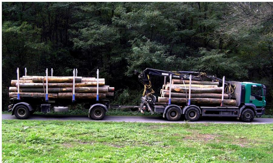
*Slika 7 - Kamionska kompozicija s hidrauličnom dizalicom*
