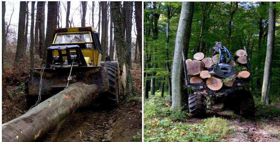
Slika 71 a, b - Oštećenje stabala uz vlagu šumskim zglobnim traktorima
