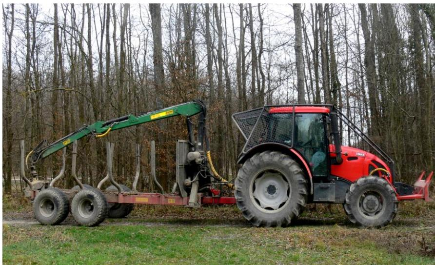
*Slika 5 - Adaptirani poljoprivredni traktor s poluprikolicom i hidrauličnom dizalicom*
