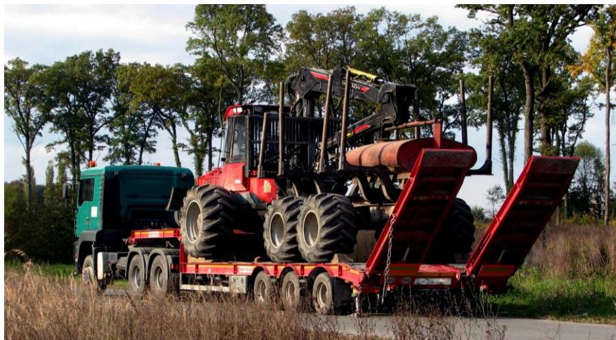
*Slika 1 - Preseljenje forvardera niskonosećom prikolicom*
