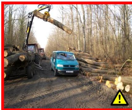
*Slika 47 b - Vozilo u radnom prostoru dizalice*
