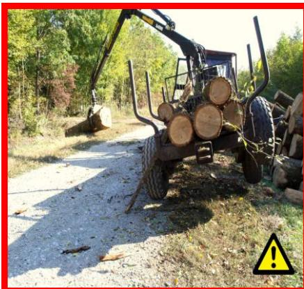
Slika 50 a, b - Dizanje kotača od tla prilikom utovara
