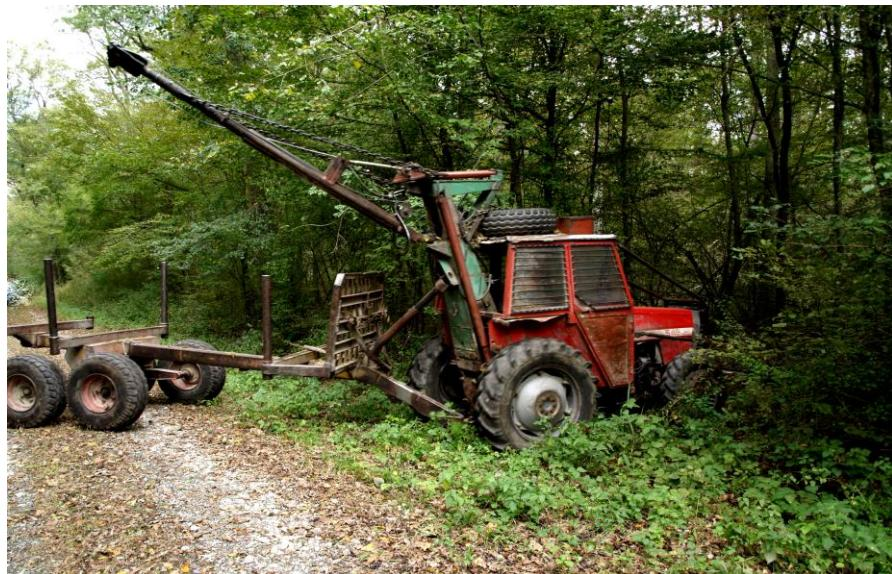
*Slika 4 - Adaptirani poljoprivredni traktor s poluprikolicom i mehaničko-hidrauličnom dizalicom*
