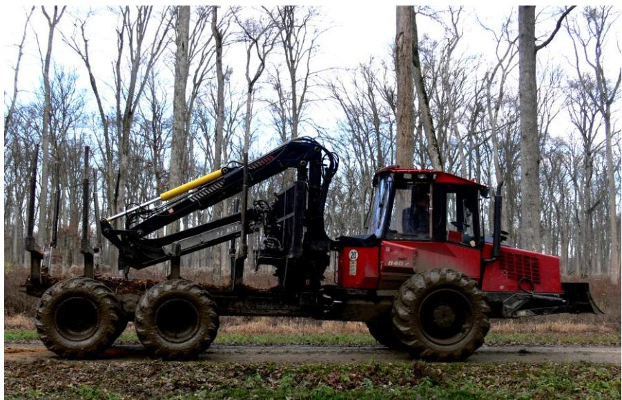
*Slika 6 - Šumski zglobni traktor s poluprikolicom i hidrauličnom dizalicom (forwarder)*
