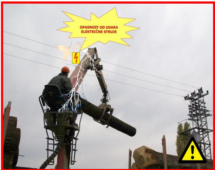
Slika 66 - Utovar ispod elektrovoda
