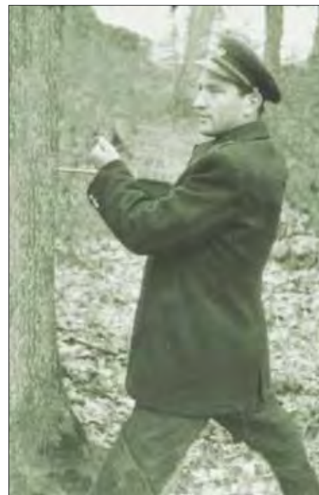
Mladi lugar Albert radi na uzimanju izvrtaka Presslerovim svrdlom
