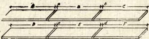
Sl. 6. Izrada kontrolnih dasaka i proba za utvrđivanje vlage.
