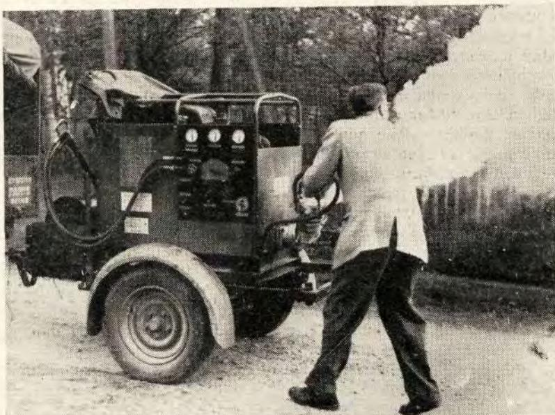
Fig. 14. Appareil fumigène continu et mobile.
