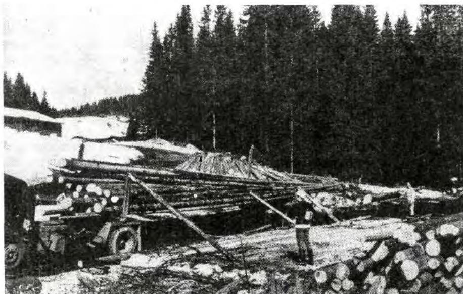
Slika 8. Utovar cijelih debala sa tla u kamion uz upotrebu radio-tehnike
