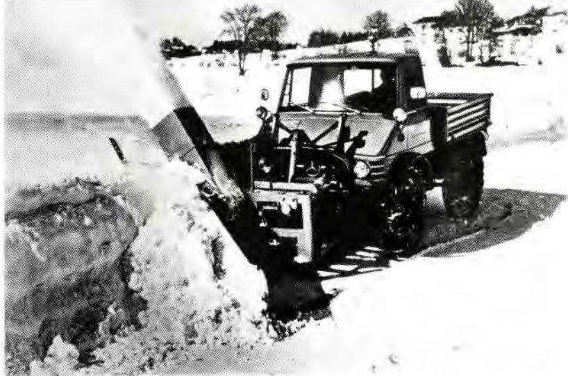
Dobri prenosni odnosi mjenjača Unimoga omogućuju prilagodenje brzine čišćenja sniježnom pokrivaču.
