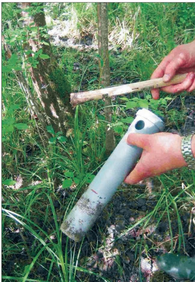
Slika 2. Uzorkovanje tla za pripremu kompozitnih uzoraka
