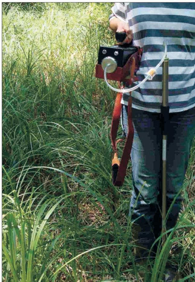
Slika 3. Mjerenje ugljikovodika u zraku tla.
