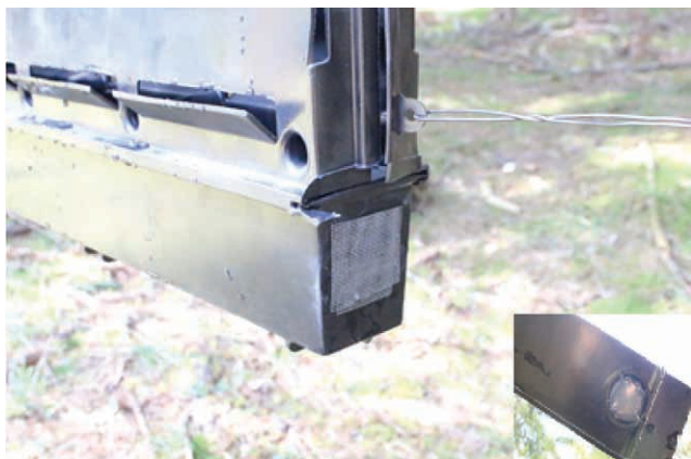
Slika 1. Modificirana mokra naletno barijerna crna Theysohn® feromonska klopka s mrežicom na lovnoj posudi. Detalj prikazuje dno lovne posude koje je začepljeno silikonom
