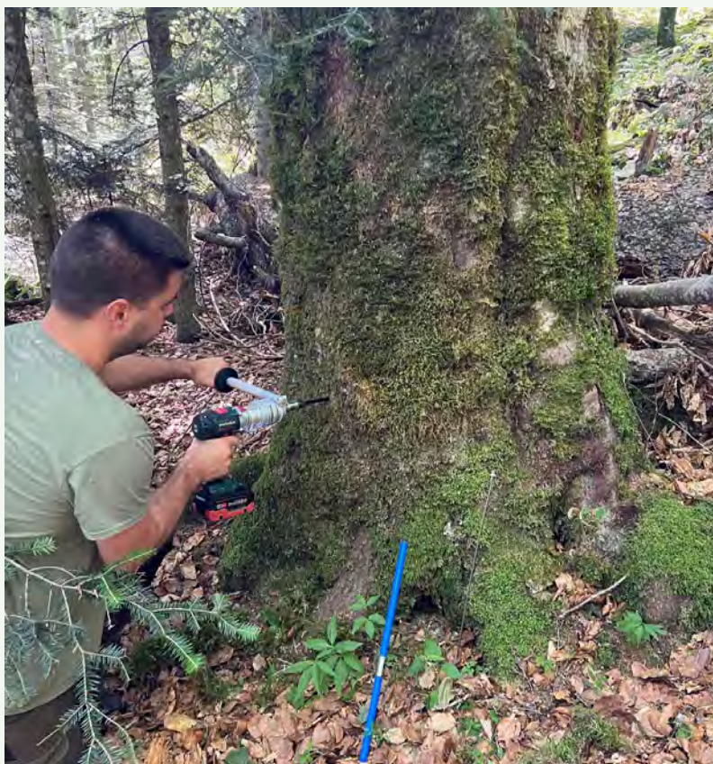
Dendrokronološkim metodama utvrđene su starost i prirast stabla. Za uzorkovanje je korišteno Presslerovo svrdlo pričvršćeno na akumulatorsku bušilicu.
