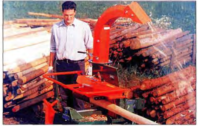
Slika 11. Jedna od jednostavnijih izvedbi stroja za cilindričnu obradu drva. Zahvaljujući ovom "izumu", tehničkim drvom postaju praktično i pravni stabalca iz prvih proreda, pa čak i iz čišćenja guštika, deblja od 4 cm. Stroj obrađuje sortimente promjera od 4 - 20 cm za najrazličitije namjene.
