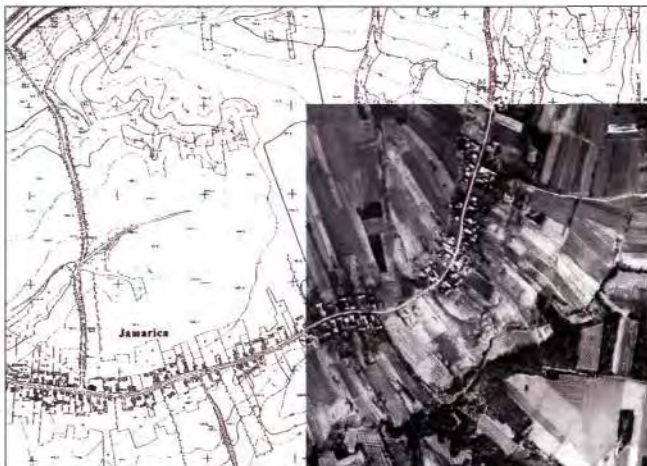
Slika 7. Spajanje (preklapanje) detalja na ODK i digitalnom ortofotu
