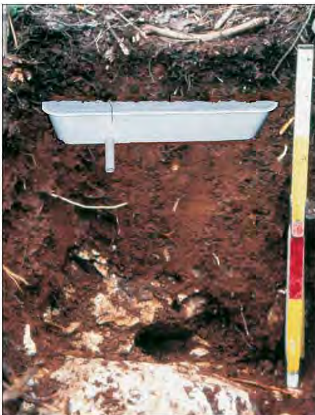
Slika 2. Crvenica s ugrađenim protočnim lizimetrom Photo 2 Chromic Cambisol with zero tension lysimeter
