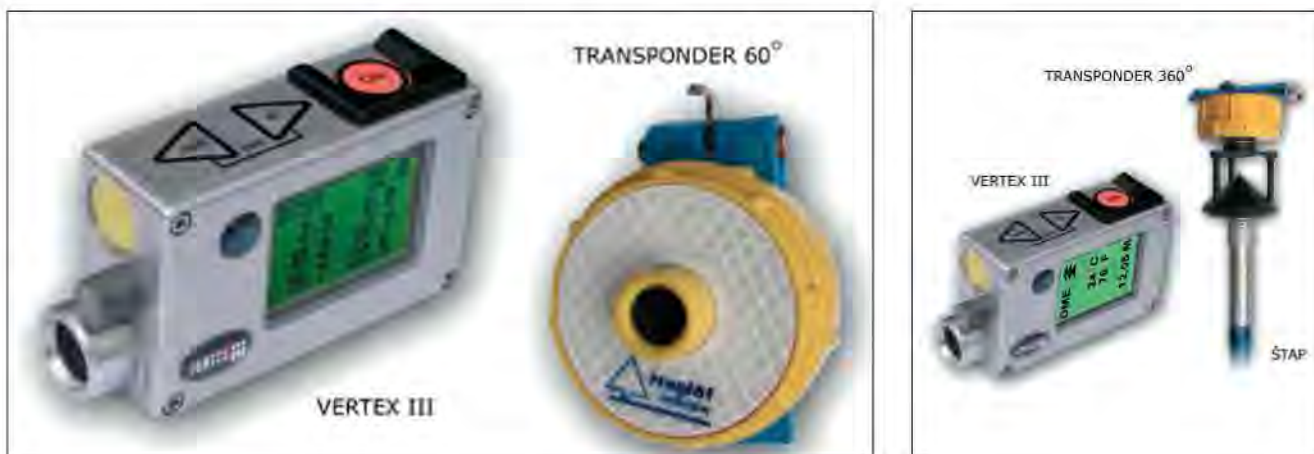
Slika 1. Vertex III – ultrazvučni visinomjer/daljinomjer, Kompelt za izmjeru visine i određivanje udaljenosti do stabla (lijeva slika), odnosno za izmjeru (udaljenosti) na krugovima zadanog radijusa (desna slika). Figure 1 Vertex III – ultrasonic hypsometer/distance measurer. A device for measuring heights and determining distances to a tree (left), and measuring (distances) in the circles of a set diameter (right)
